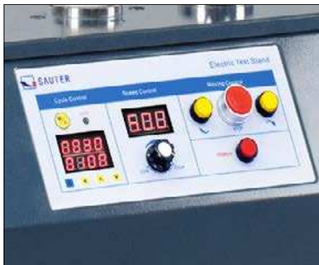
Panel de control de gama alta - Indicación digital de velocidad - Función digital de repetición
