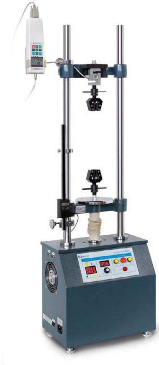
Banco de pruebas con motor eléctrico para mediciones estándares
